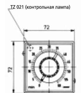
Вырез в панели щита 68 +0,70 × 68 +0,70 Макс. толщина панели 5 мм
